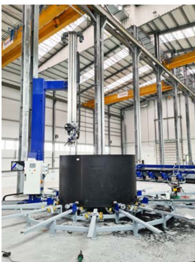
Technologia „standardowa” z wykorzystaniem gotowych arkuszy tworzywa AmargTank ClassicWeld ®
