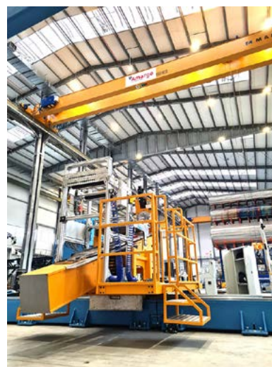
Technologia nawojowa (kompozyty) AmargTank Composite
