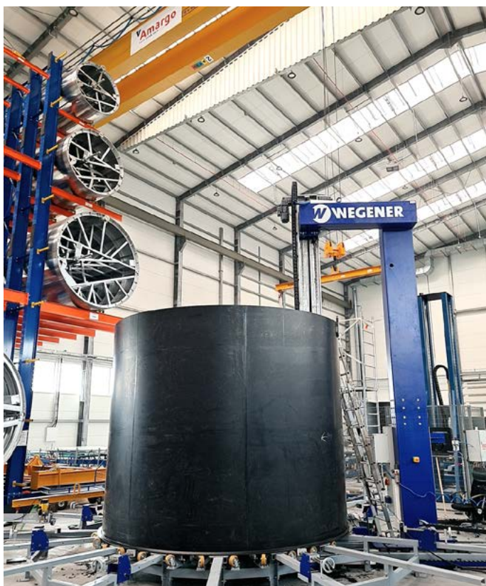
Zbiornik produkowany technologią AmargTank ClassicWeld®
