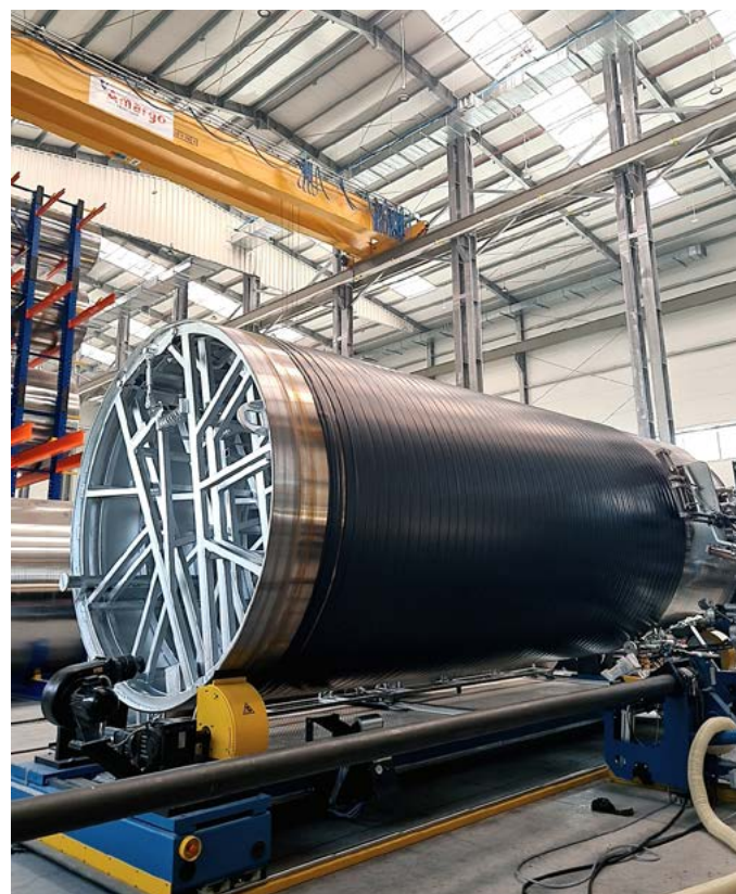
Zbiornik produkowany technologią AmargTank SafeSeamLess®
