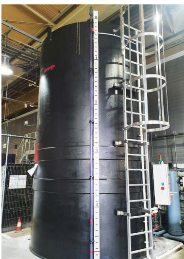
Fot. 1. Zbiornik magazynowy powłok wodorocieńczalnych.
