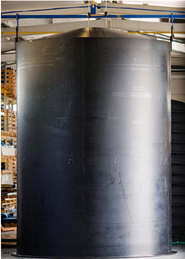
Zbiornik chemoodporny zgrzewany z płyt – widoczne miejsce zgrzewu płyty
