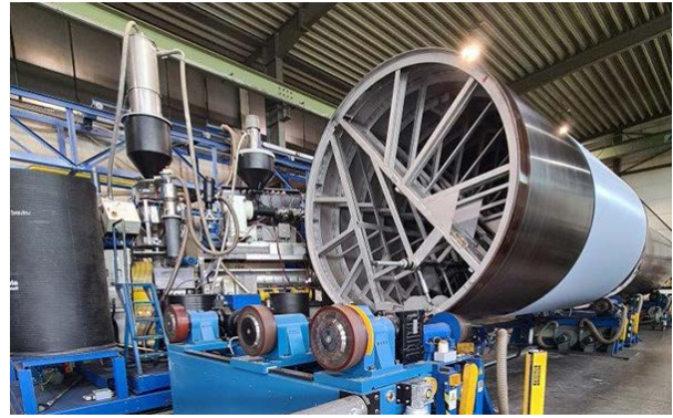
Produkcja bezspoinowych zbiorników w technologii nawojowej
