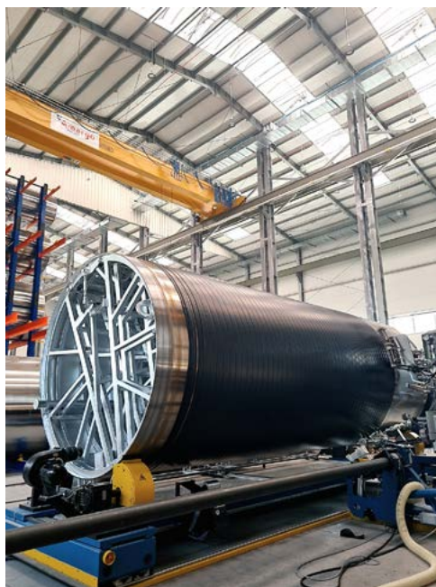
Technologia nawojowa (tworzywa termoplastyczne) AmargTank SafeSeamLess / MultiLayer / MultiLayer DoubleWall®
