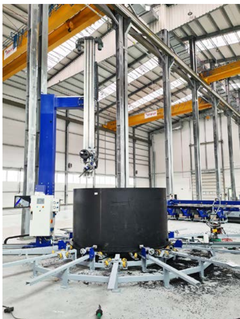
Technologia „standardowa” z wykorzystaniem arkuszy płyty tworzywa AmargTank ClassicWeld®
